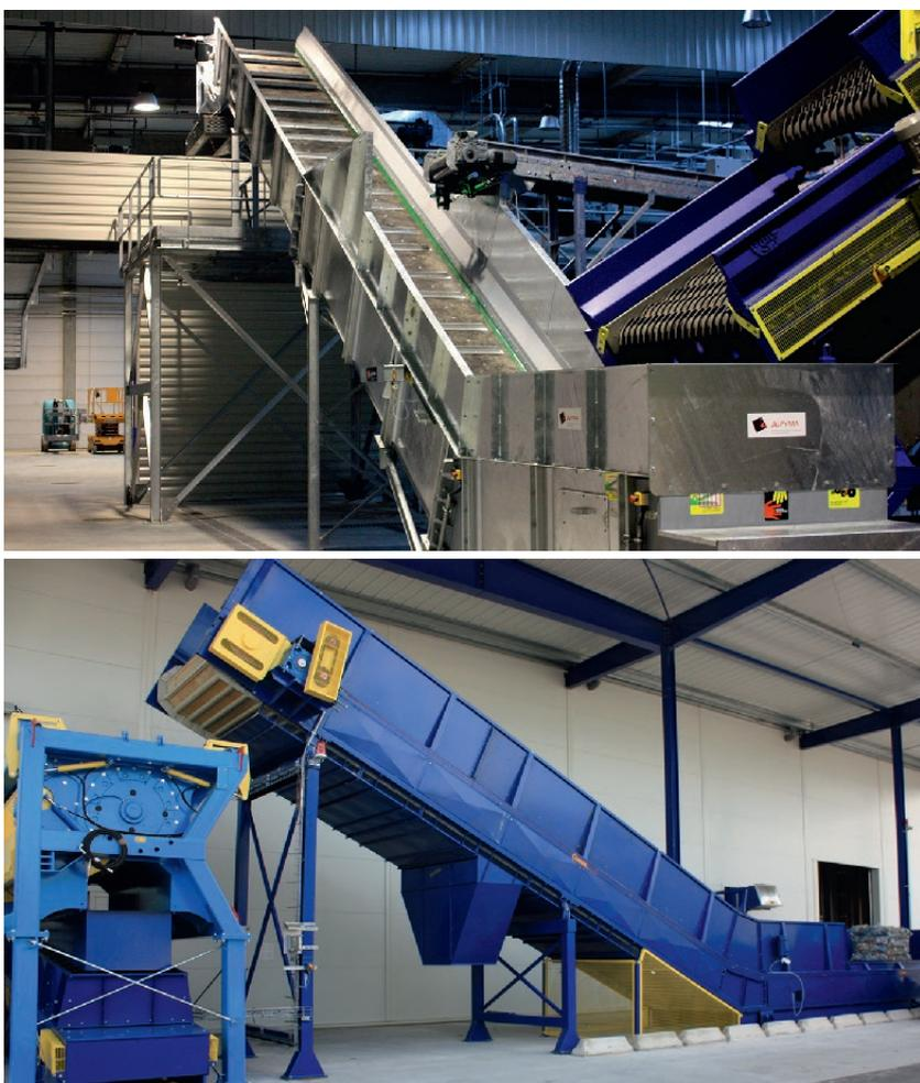
Notre gamme de trémies d'alimentation permet de réguler parfaitement le flux de matière de nos installations. Il existe différentes technologies de trémies qui, selon le poids, le volume, la densité et la matière stockée, s'adaptent parfaitement à vos besoins. Ce sont des trémies de «réception» et servent de «réserve». Cela permet de gagner en efficacité et en pureté lors de l'extraction des matières premières.
