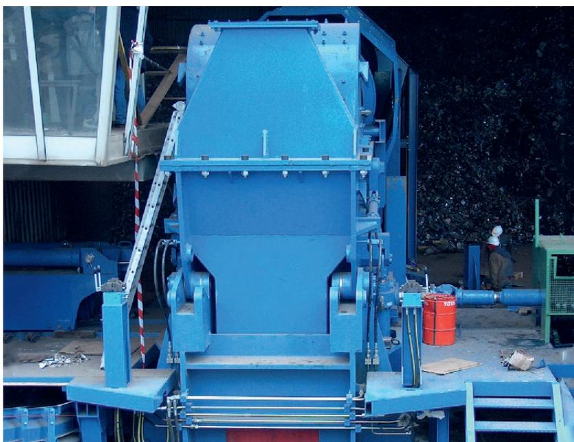
Nos équipes conçoivent et installent des broyeurs de 1000 ch. pouvant porter un volume de production de 50 t/h de ferrailles, ils ont une densité supérieure à 1.
