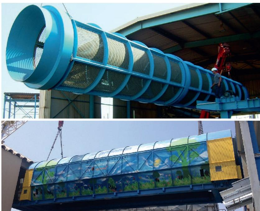
Le choix d'un trommel est défini par nos ingénieurs, en fonction de la nature des produits à traiter ainsi que le process de tri retenu. Notre gamme de trommel, ou cribles rotatifs, se décline en différents diamètres et longueurs suivant vos besoins.
