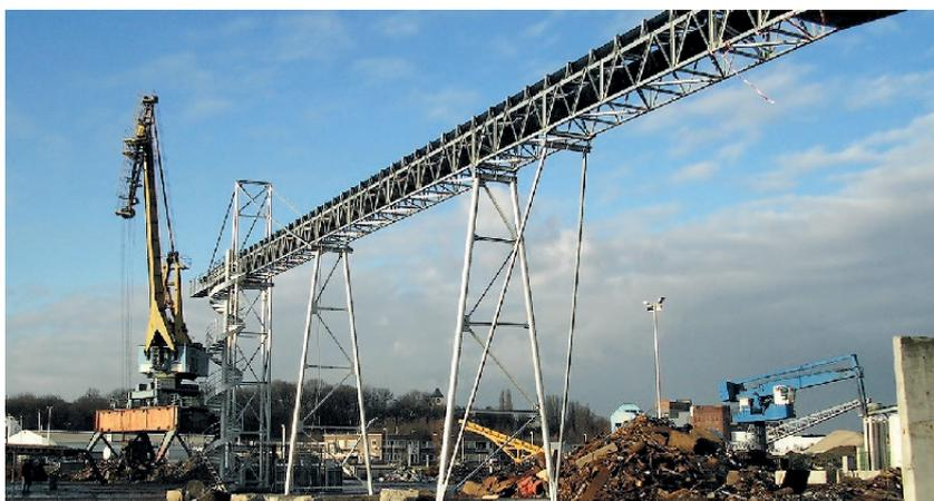
Nous avons étudié une conception particulière et originale qui garantit une étanchéité poussée et une capacité de transport optimisée. Nos convoyeurs sont conçus avec des matériels standards, de qualité (rouleaux, paliers, bandes) et d'une durée de vie importante. Nos convoyeurs sont de conception modulaire.
