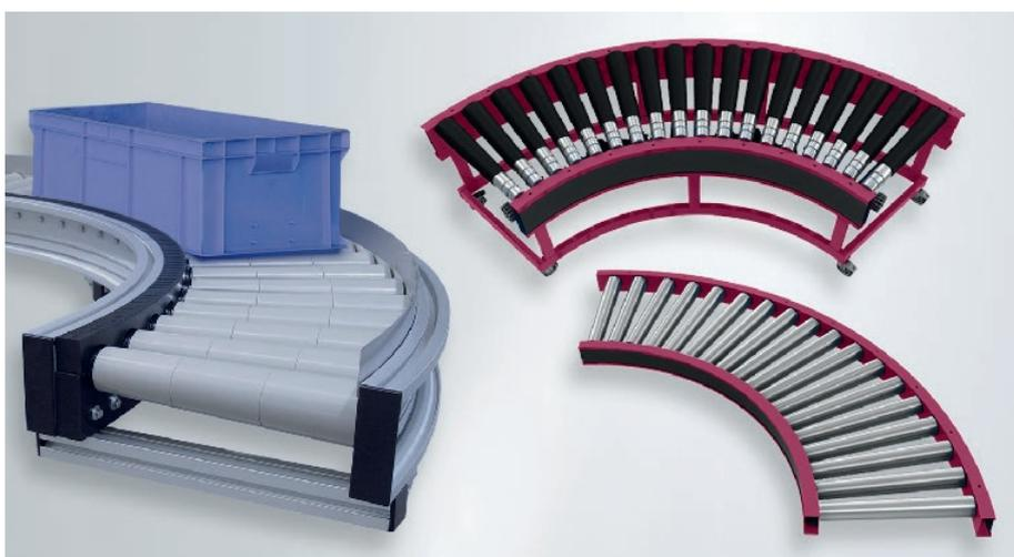
Les courbes à rouleaux modifient le sens de transport des produits. Des rouleaux coniques maintiennent l'alignement de la charge entre les profilés latéraux. Nous pouvons les commander à l'aide de moteurs 24 V.
